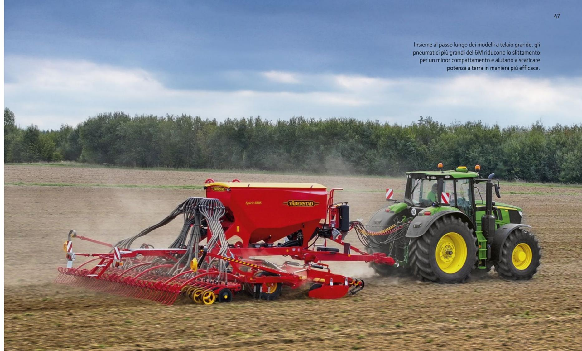
Insieme al passo lungo dei modelli a telaio grande, gli pneumatici più grandi del 6M riducono lo slittamento per un minor compattamento e aiutano a scaricare potenza a terra in maniera più efficace.
