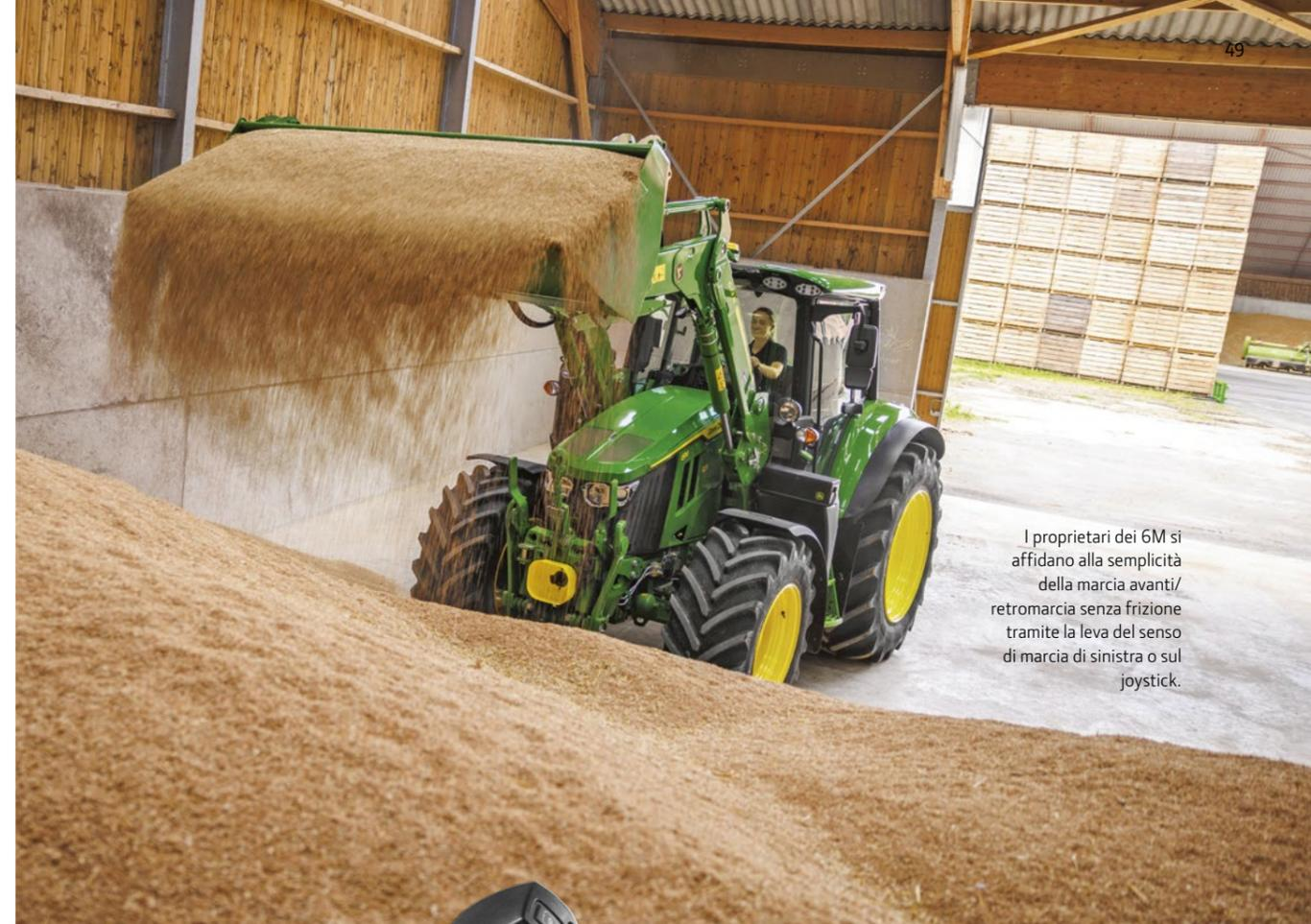
I proprietari dei 6M si affidano alla semplicità della marcia avanti/retromarcia senza frizione tramite la leva del senso di marcia di sinistra o sul joystick.
