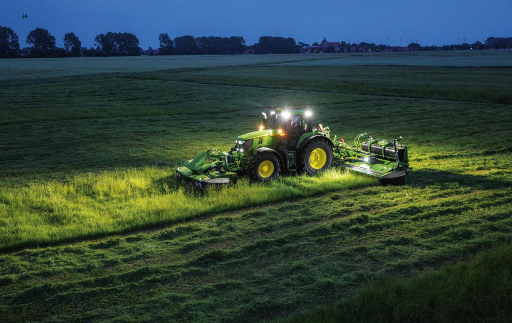
Le luci di lavoro sono integrate in modo intelligente nella parte anteriore, posteriore e sui lati del bordo del tetto per evitare eventuali danni in presenza di rami bassi.
